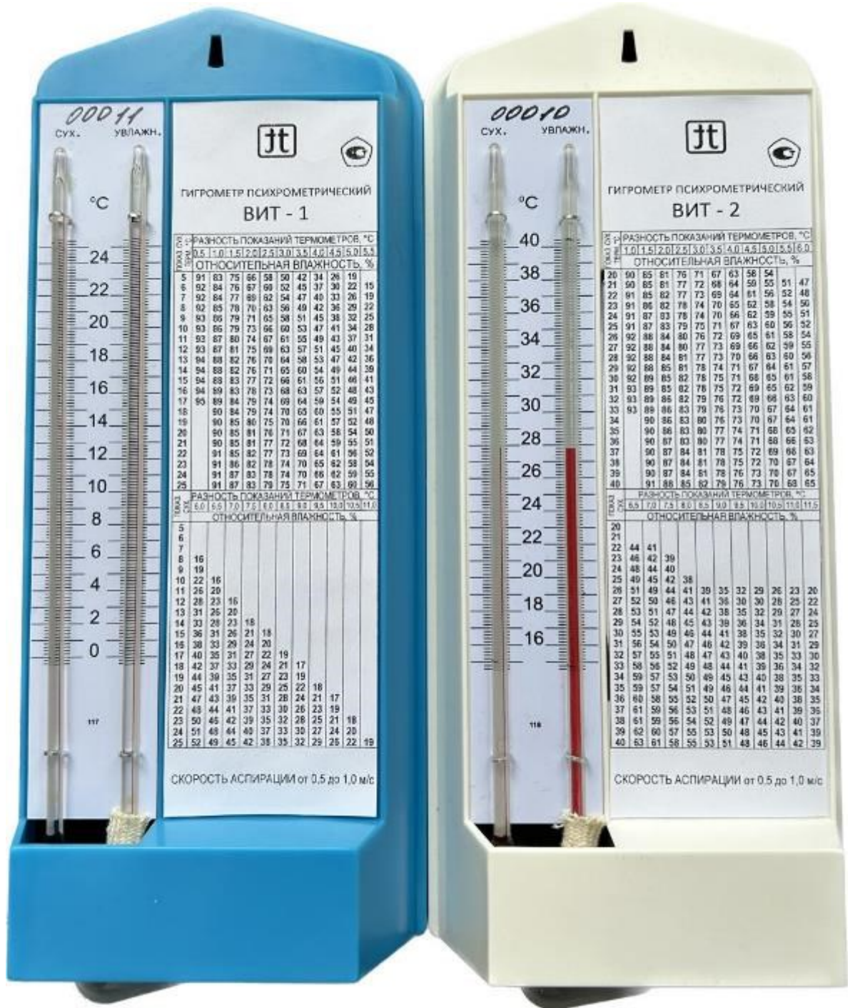
Рисунок 1 – Общий вид гигрометров психрометрических ВИТ-1 и ВИТ-2
